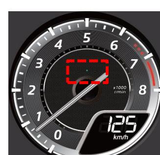
このとき他社のようなメーター全体をカラフルに点灯させる方式も検討しましたが、魂動デザインのインテリアの質感を損なわないよう、必要最小限のドットランプ表示としました。
